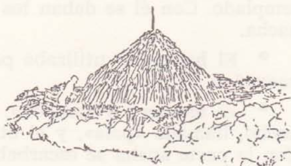
Horno, construcción del horno, colocación de la leña
