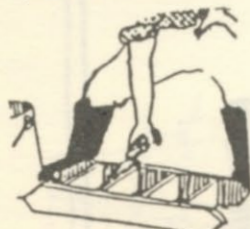
Con la estopa se humedece, para que no quite el agua al barro.
