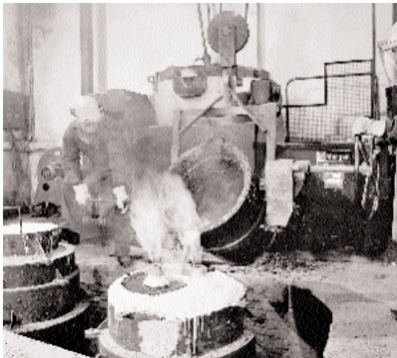
Vertido de la colada
