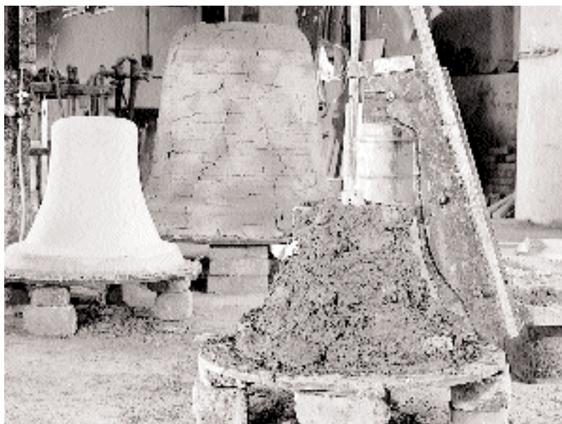
Elaboración del molde de una campana en el taller de Manuel Quintana en Saldaña (Palencia)
