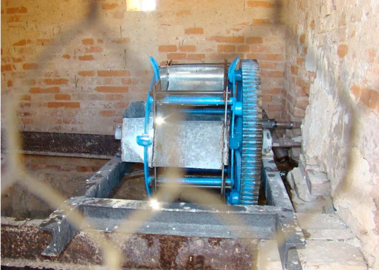
Mecanismo interior de la Represa para elevar los cangilones cargados de agua
