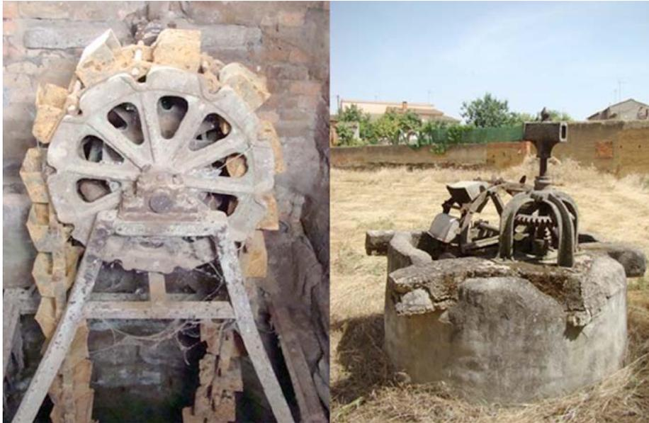
Otros sistemas de extracción de agua mediante cangilones y noria
